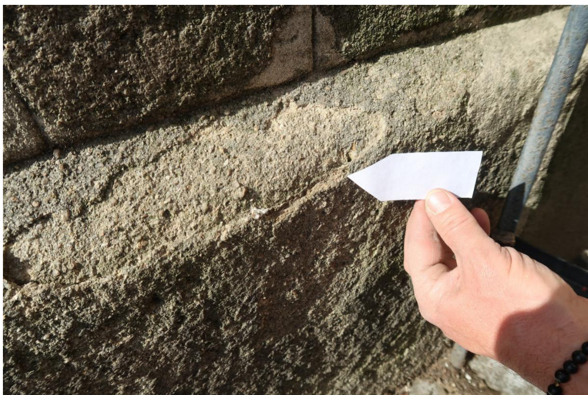
Stav před restaurováním – sokl sochy sv. Jana Nepomuckého, odběr vzorků na salinitu, koroze originální hmoty
